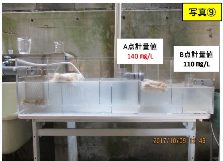
比較表5 ■GS流入原水ノルマルヘキサン濃度8500 mg/Lを160L連続注水 ※20L/分
