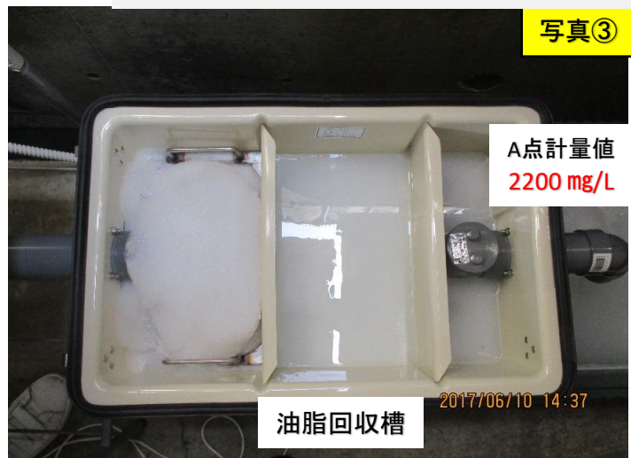
比較表2 ■GS流入原水ノルマルヘキサン濃度7353 mg/Lを140L連続注水 ※2.8L/分
