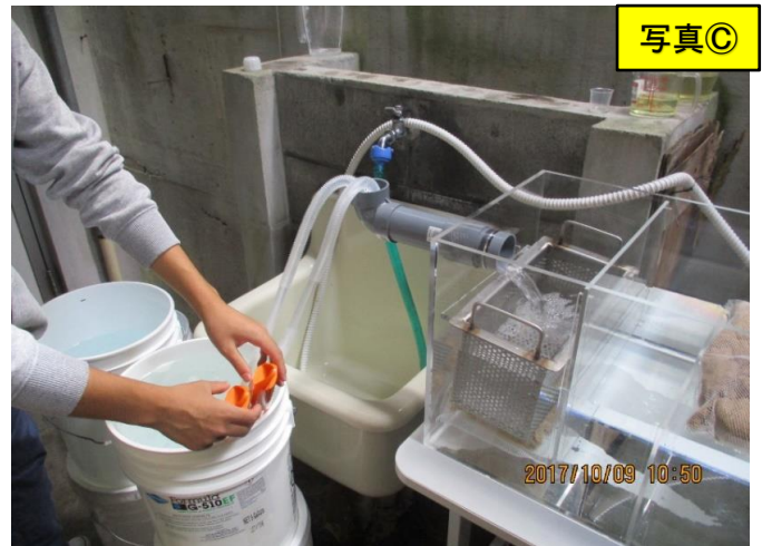
食洗機の洗浄槽タンク排水を再現
