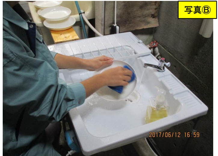
比較表1 ■GS流入原水ノルマルヘキサン濃度730 mg/Lを140L連続注水 ※4.6L/分
