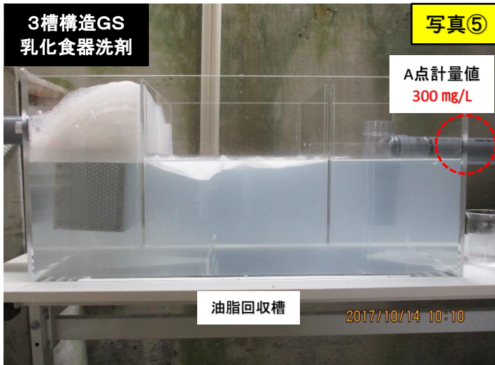
比較表4 ■GS流入原水ノルマルヘキサン濃度3000 mg/Lを160L連続注水 ※20L/分
