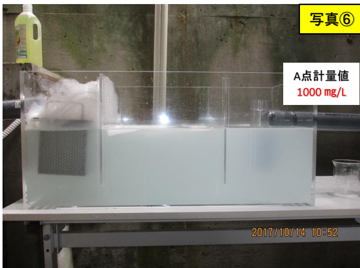
比較表5 ■GS流入原水ノルマルヘキサン濃度8500 mg/Lを160L連続注水 ※20L/分
