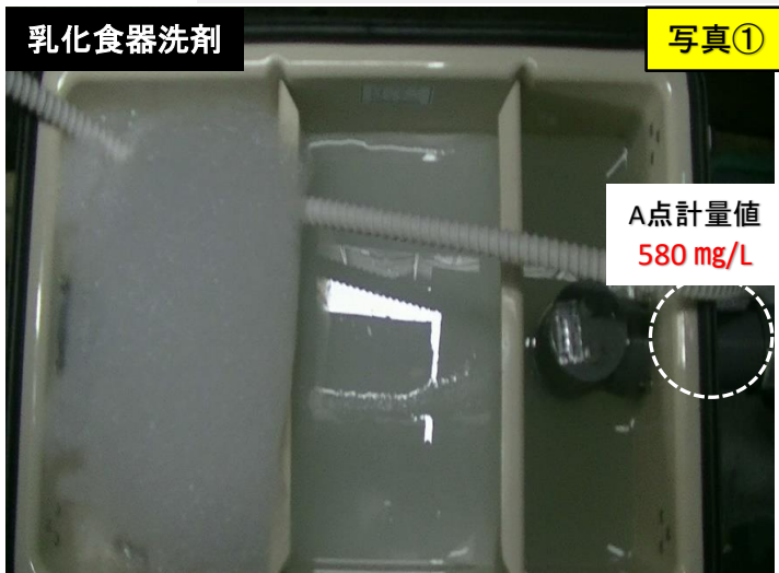
比較表2 ■GS流入原水ノルマルヘキサン濃度7353 mg/Lを140L連続注水 ※2.8L/分
