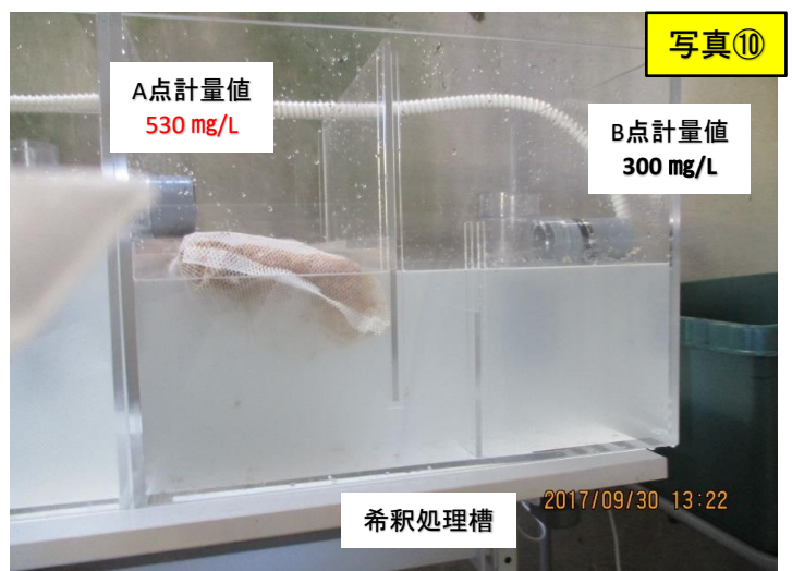
比較表5 ■GS流入原水ノルマルヘキサン濃度8500 mg/Lを160L連続注水 ※20L/分
