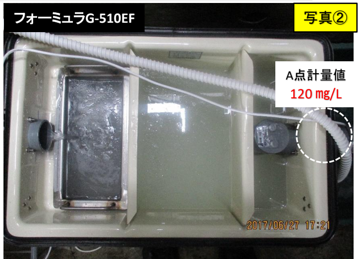
比較表2 ■GS流入原水ノルマルヘキサン濃度7353 mg/Lを140L連続注水 ※2.8L/分
