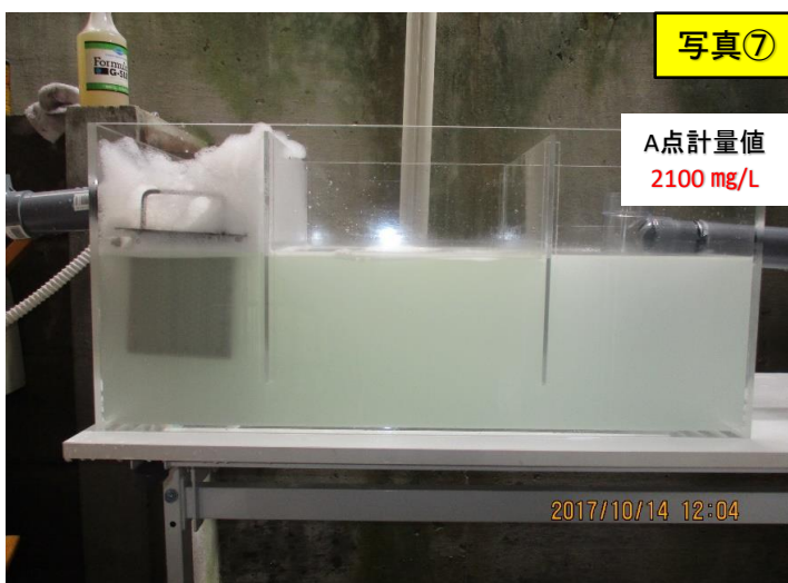
比較表5 ■GS流入原水ノルマルヘキサン濃度8500 mg/Lを160L連続注水 ※20L/分
